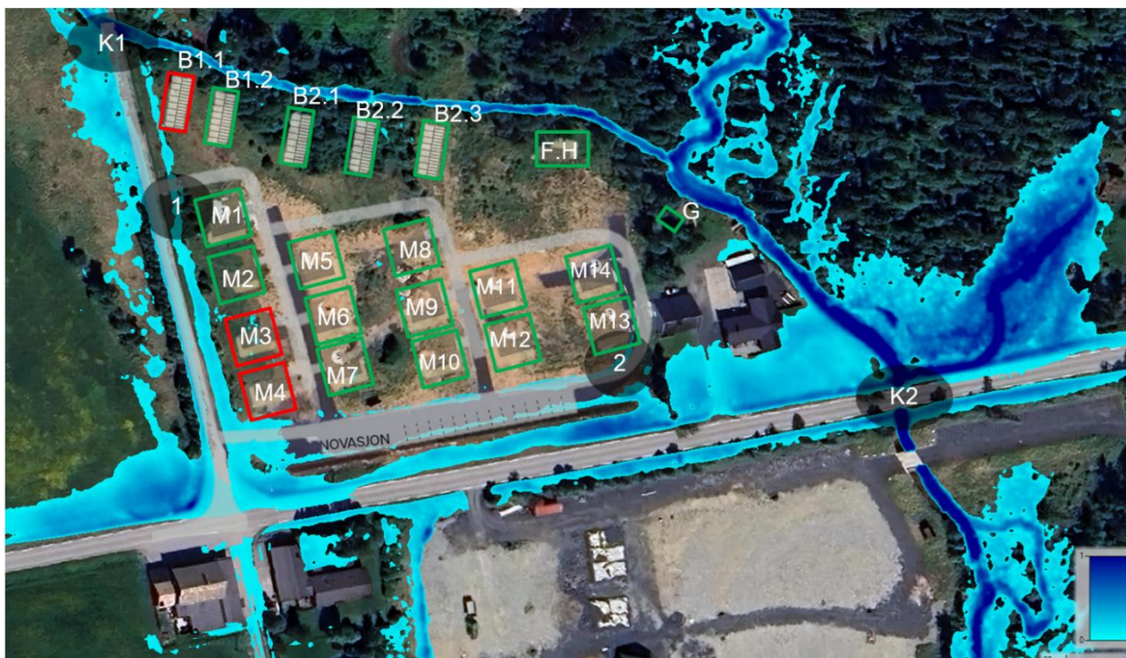
Figur 10: Vanndybde ved middelflom ( Q_M ), skalert fra 0,05-1 m. Planlagte bygg som er i kontakt med vannet før utført flomsikring er markert med røde bokser, og bygg vurdert utenfor risiko markert med grønne bokser.
